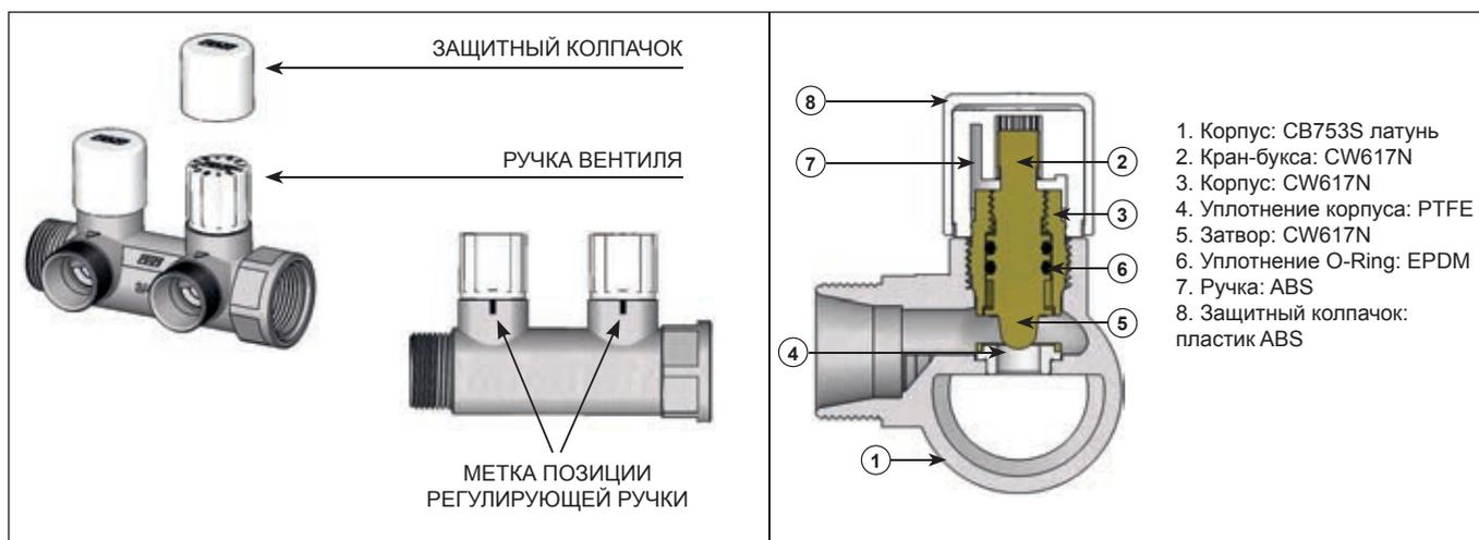
Коллектор с запорно-балансировочными вентилями позволяет точно отрегулировать систему и по метке на ручке вентиля определить его установочное положение. Вентили вращаются на 360° между позициями: 0 - полностью закрытый и 5.5 - полностью открытый. Чтобы осуществить регулировку снимите красный колпачок и поверните белую тарированную ручку до нужного значения.
