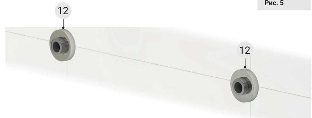
**2.4.** Установите на эксцентрики (рис. 6) декоративные отражатели, служащие для маскировки мест подключения полотенцесушителя в водорозетки.
