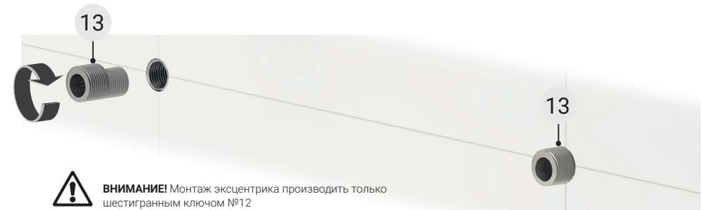
**ВНИМАНИЕ!** Монтаж эксцентрика производить только шестигранным ключом №12
