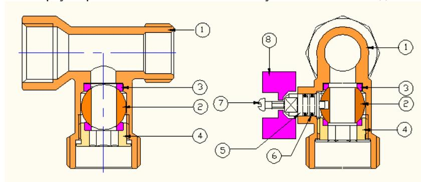
прессования с гальванопокрытием из никеля. В боковом отводе тройника расположен шаровой затвор из хромированной латуни 2, который приводится в движение латунным штоком 5 с помощью ручки 8 из PA-6 пластика. Шток имеет сальниковое уплотнение из двух колец 6 из EPDM. Уплотнение шарового затвора выполнено из тефлоновых колец 3 с помощью латунной прижимной гайки 4. Гайка имеет шестигранный проход (под ключ).
