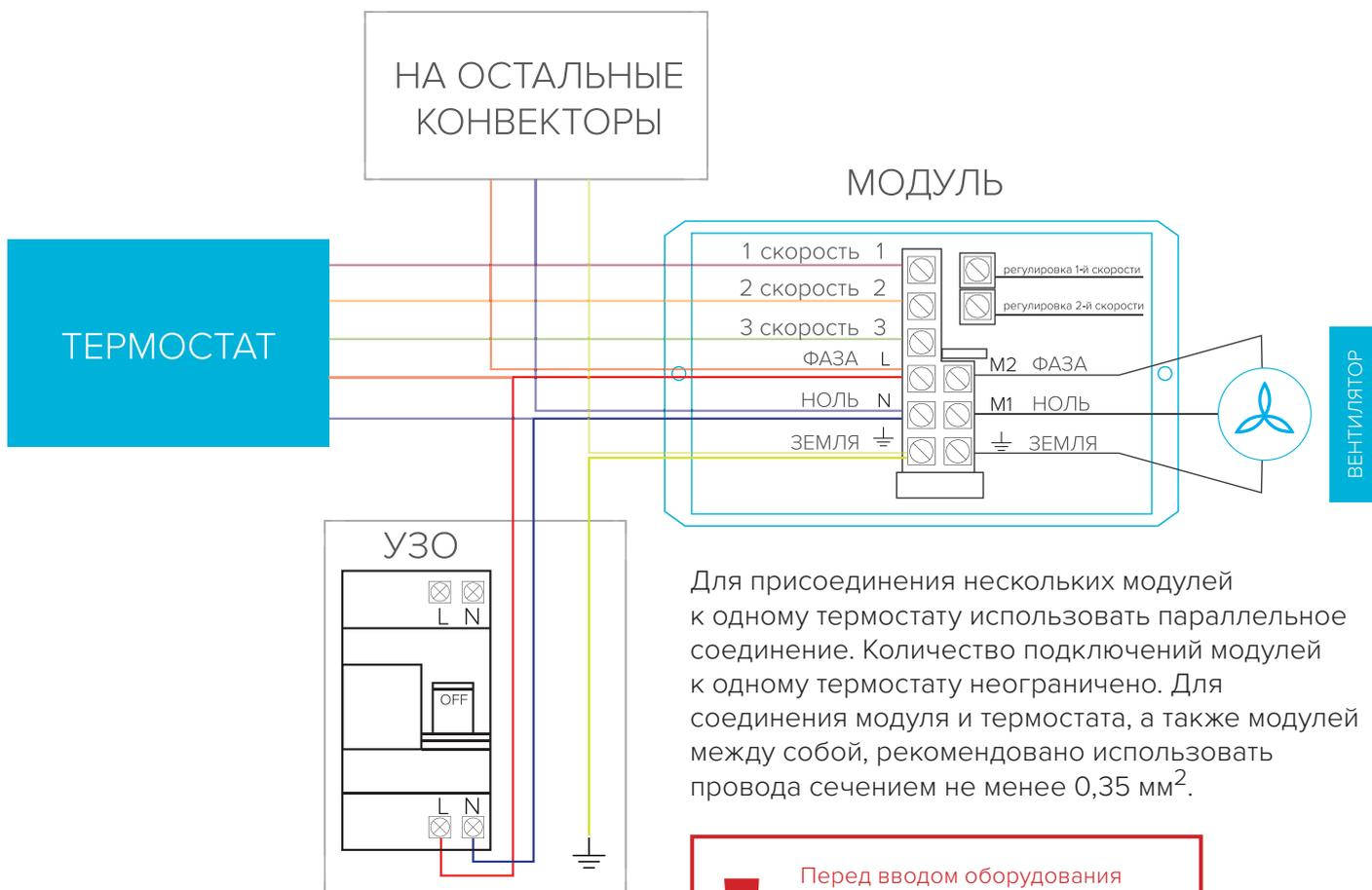
Для присоединения нескольких модулей к одному термостату использовать параллельное соединение. Количество подключений модулей к одному термостату неограничено. Для соединения модуля и термостата, а также модулей между собой, рекомендовано использовать провода сечением не менее  $0,35 \text{ мм}^2$ .
